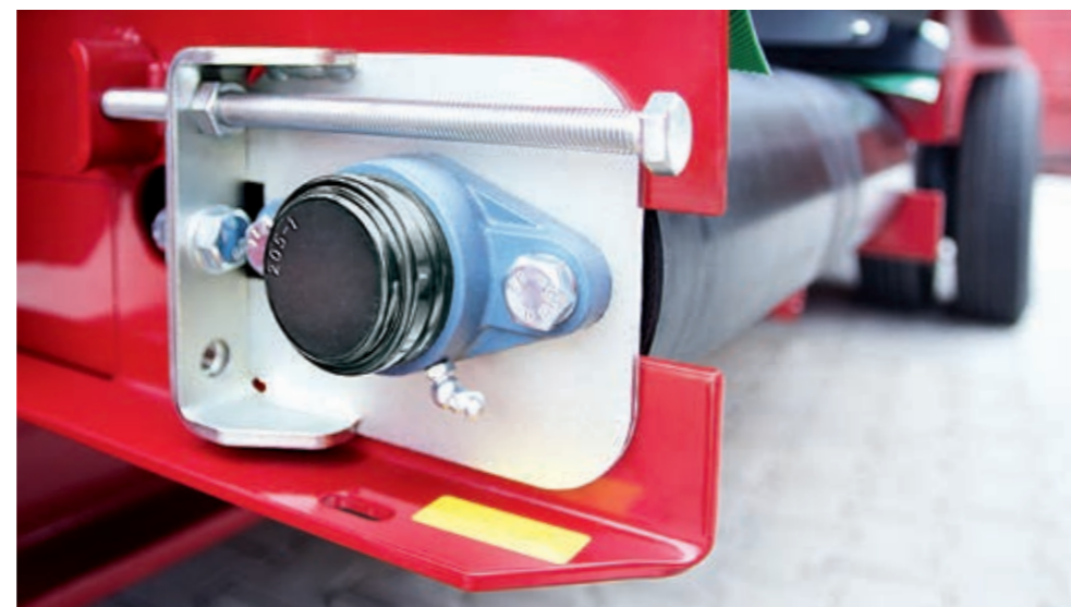
Station tendeuse pour la courroie en caoutchouc du tapis roulant, avec palier applique à deux trous de fixation et couvercle de protection
