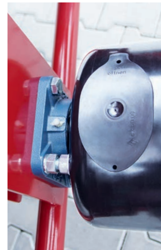
Arbre de transmission passant du remorqueur à la transmission de la mélangeuse, avec tête de protection pour l'arbre
